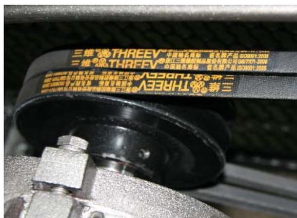
图 7-1-7 空压机皮带
