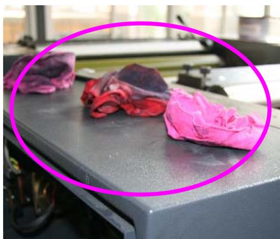
图 2-1-7 遗留在机器上使用的擦机布
