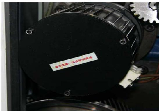
图 8-1-6 墨辊直驱动电机
