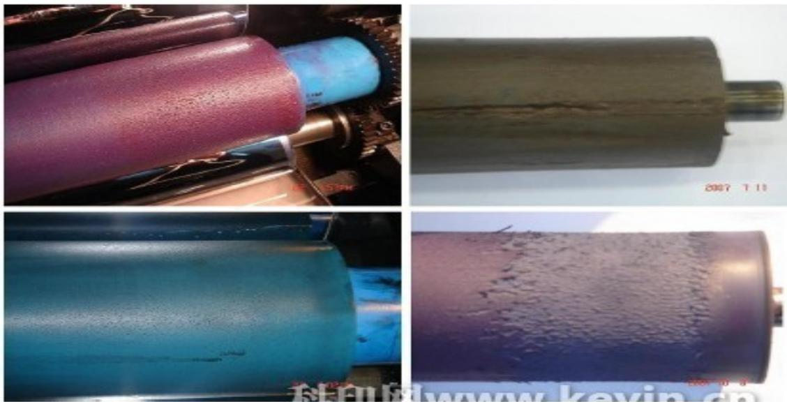
上图压力过大而造成的胶辊损伤
