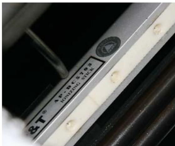
图 6-1-36 静电消除装置
