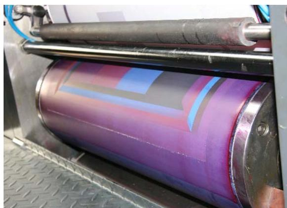
图 7-1-10 包裹橡皮布的橡皮滚筒
