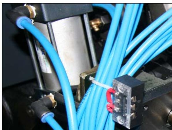
图 9-1-7 气管及气缸接头
