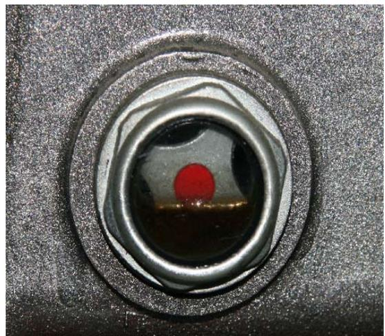
图 5-1-4 空气压缩机观油镜
