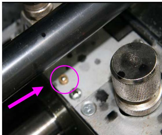
图 2-1-4 侧规手工加油油杯
