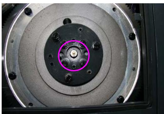
图 8-1-1 压印滚筒注油油嘴（左右各一）
