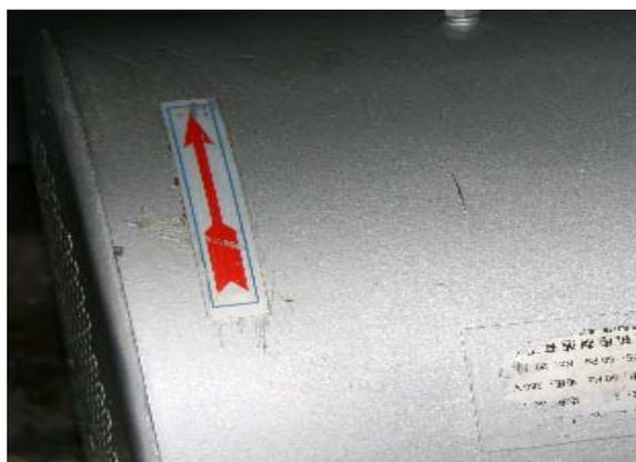
图 2-1-5 主电机风扇旋转方向指示
