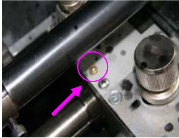
图 6-1-13 侧规加油杯
