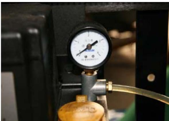
图 4-1-3 油压表（输纸机处）
