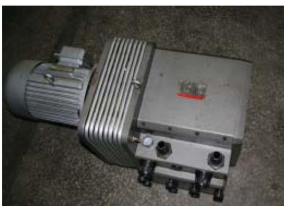
图 6-1-40 真空压力复合气泵
