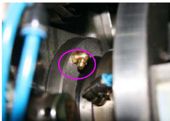
图 8-1-4 印版滚筒注油油嘴（左右各一）
