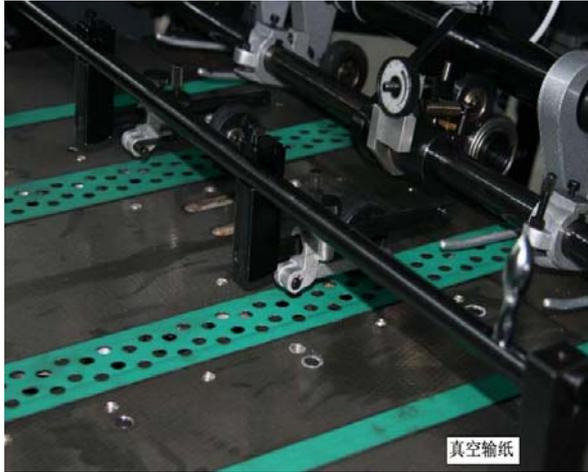
图 5-1-9 输纸机线带
