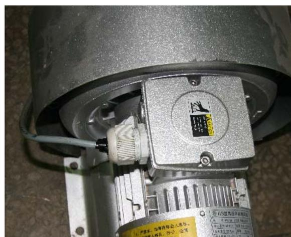
图 6-1-34 喷粉吹风的电机
