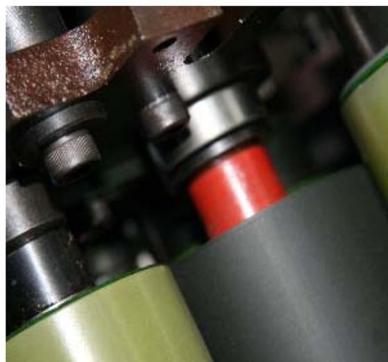
图 5-1-32 靠版起落机构
