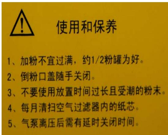
图 6-1-31 喷粉装置使用保养标识
