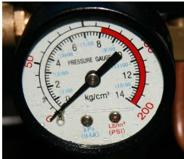
图 2-1-12 空压机工作压力严禁超过 8kg
