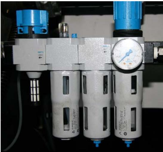
图 5-1-1 气源滤清器（气源三连体）
