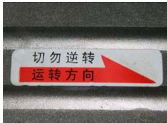
图 2-1-6 气泵旋转方向指示
