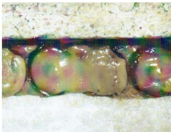
图 7-1-14 粘满污垢的收纸循环链条
