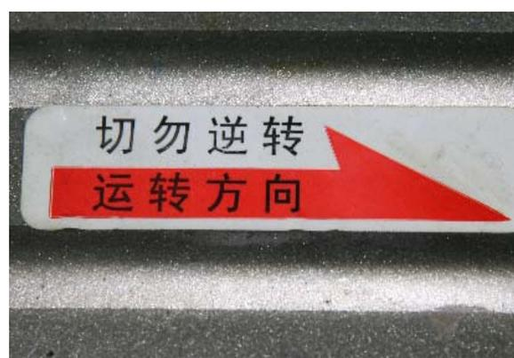
图 6-1-41 气泵旋转方向标识
