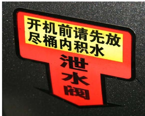
图 4-1-30 空气压缩机每班排水
