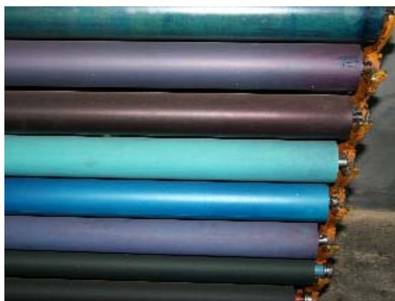
图 5-1-33 拆卸后的墨辊
