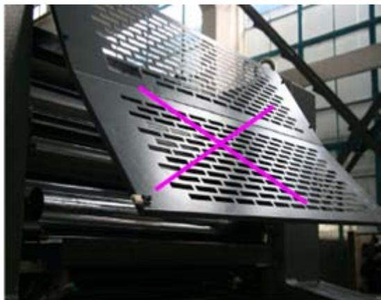
图 2-1-9 机器防护罩严禁打开
