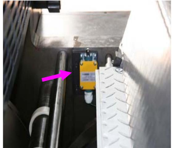
图 1-1-4 色组间连接踏脚板下接触开关
